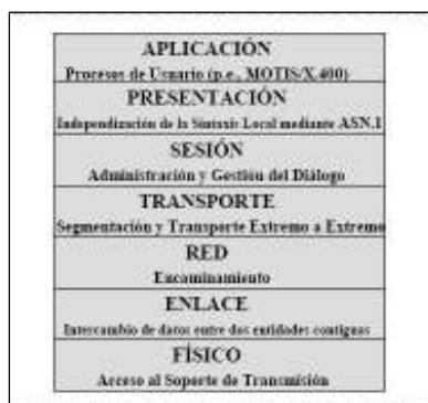
Figura 1.8.- Modelo OSI de ISO: Funciones de los niveles.
