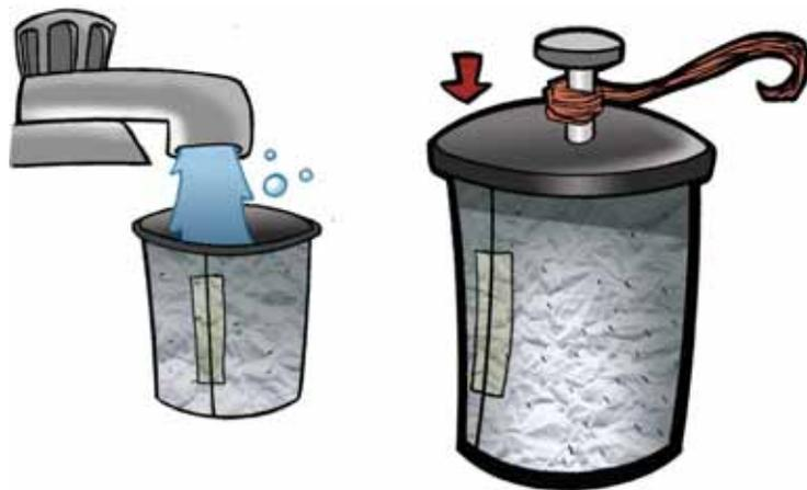
5 Por último, enreda otro trozo de alambre pelado alrededor del aluminio, dejando un tramo suficientemente largo para que pueda tocar la cabeza del clavo (de preferencia, deja el tramo suelto con el forro y sólo pela la otra punta que tocará el clavo).
