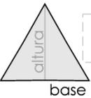
$$\text{Área triángulo} = \frac{\text{base} \cdot \text{altura}}{2}$$
