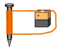
Enrollen el alambre en el clavo y coloquen uno de los extremos en la pila como en la ilustración. Tengan cuidado al hacerlo, pues aunque la electricidad de una pila no es suficiente para ocasionar molestias al tocarlo con las manos, si quien lo hace tiene dispositivos eléctricos en su cuerpo, como un marcapasos, se verá afectado por la pequeña carga de electricidad.
